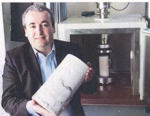
Blaise Dupré, directeur du Codem, devant la machine d'essai mécanique permettant des pressions jusqu'à 1 200 kN.
